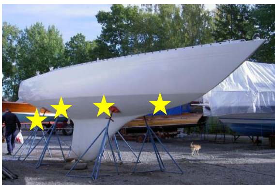
Figur 1. Mätpunkter på båtar mätta av Happy Boat AB. Mätningar utfördes 10-30 cm nedanför vattenlinjen på både styrbord och babord sida enligt bilden (styrbord bak, styrbord mitt, styrbord för, babord för, babord mitt och babord bak plus ömse sidor av roderet). På motorbåtar utan roder mäts på akterspegeln och på snipor mäts på drevstocken.
