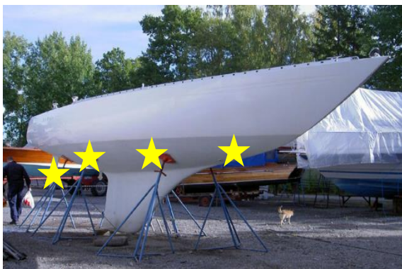
Figur 1. Mätpunkter på båtar mätta av Happy Boat AB. Mätningar utfördes 10-40 cm nedanför vattenlinjen på både styrbord och babord sida enligt bilden (styrbord bak, styrbord mitt, styrbord för, babord för, babord mitt och babord bak plus ömse sidor av rodret). På motorbåtar utan roder mäts på akterspegeln och på snipor mäts på drevstocken.
